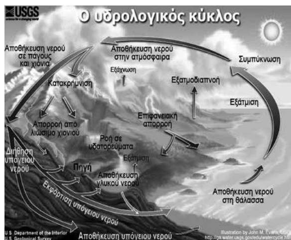
Σχήμα 2. Ο υδρολογικός κύκλος (πηγή: USGA, 2012. Ο υδρολογικός κύκλος. Εικόνα από John M. Evans, Howard Perlman, USGS και μετάφραση στα Ελληνικά από Δ. Κουτσογιάννη Ε.Μ.Π. http://ga.water.usgs.gov/edu/watercyclegreekhi.html , πρόσβαση 8 Μαρτίου 2012).
