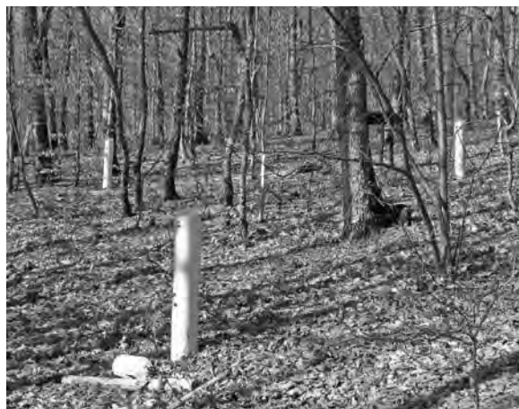
Φωτογραφία 4. Συλλεκτήρες διαπερώσας βροχής σε δάσος δρυός στην περιοχή της Όσσας.
